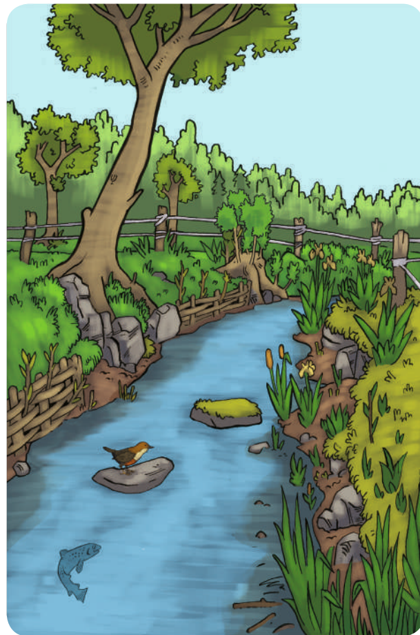
Après Reprise de berges nues et plantations en génie végétal
